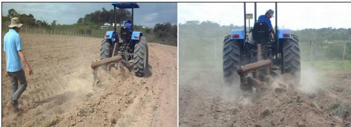
Figura 53 - Construção de terraço de base estreita com arado de três discos.
