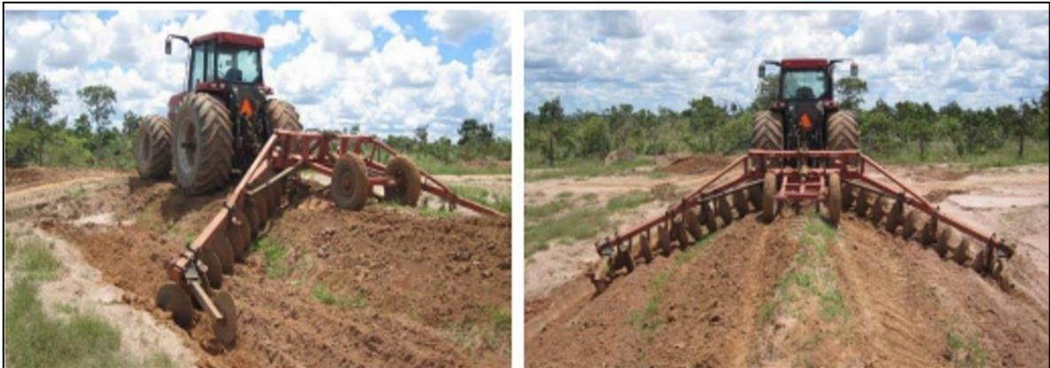
Figura 52 - Construção de terraço de base larga com arado terraceador
