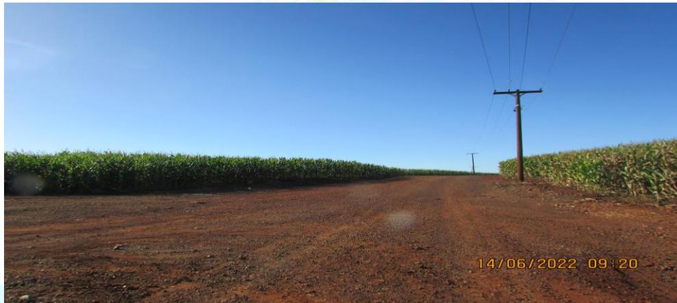
Figura 24 – Trecho inicial da estrada sem revestimento.
